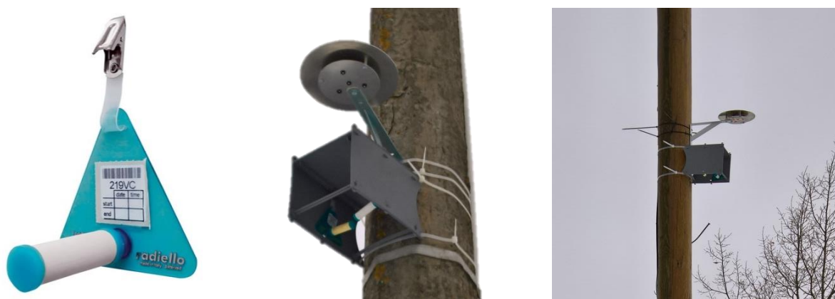
Рисунок 2. Пробоотборник Radiello и его расположение под специальным «навесом».
