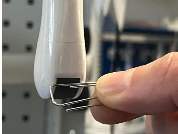
Joonis 1. Topeltkujutise testimise protseduur. Asetage metallist reflektor (näidatud klamber) vaatevälja servale. Käivitage reflektor piki anduri täielikku kumerust.
