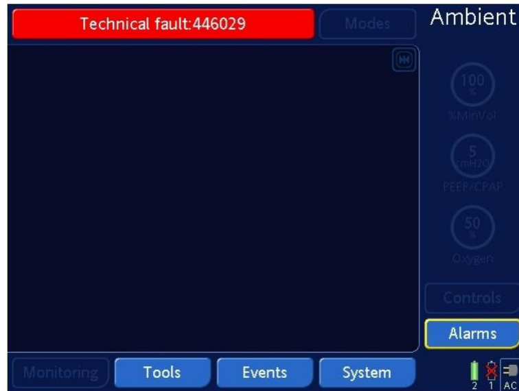
Joonis 1. Režiim Ambient state (näide, kuvatud võib olla muu tehnilise vea kood)
