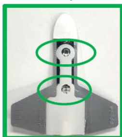
Joonis 2: defektiga TruSignal Adult/Pediatric andurid, mille puhul saatjad ja detektorid on puhtad.
