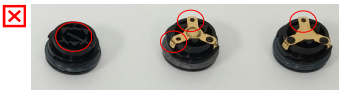
Kahjustatud patareikork - lõpetage kasutamine Metallkontakt puudub või näha on vähem kui 3 pinnast kõrgemat täppi
