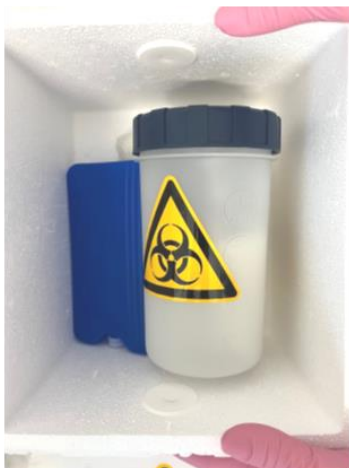
Joonis 1 Proovi pakendamine transpordiks.
